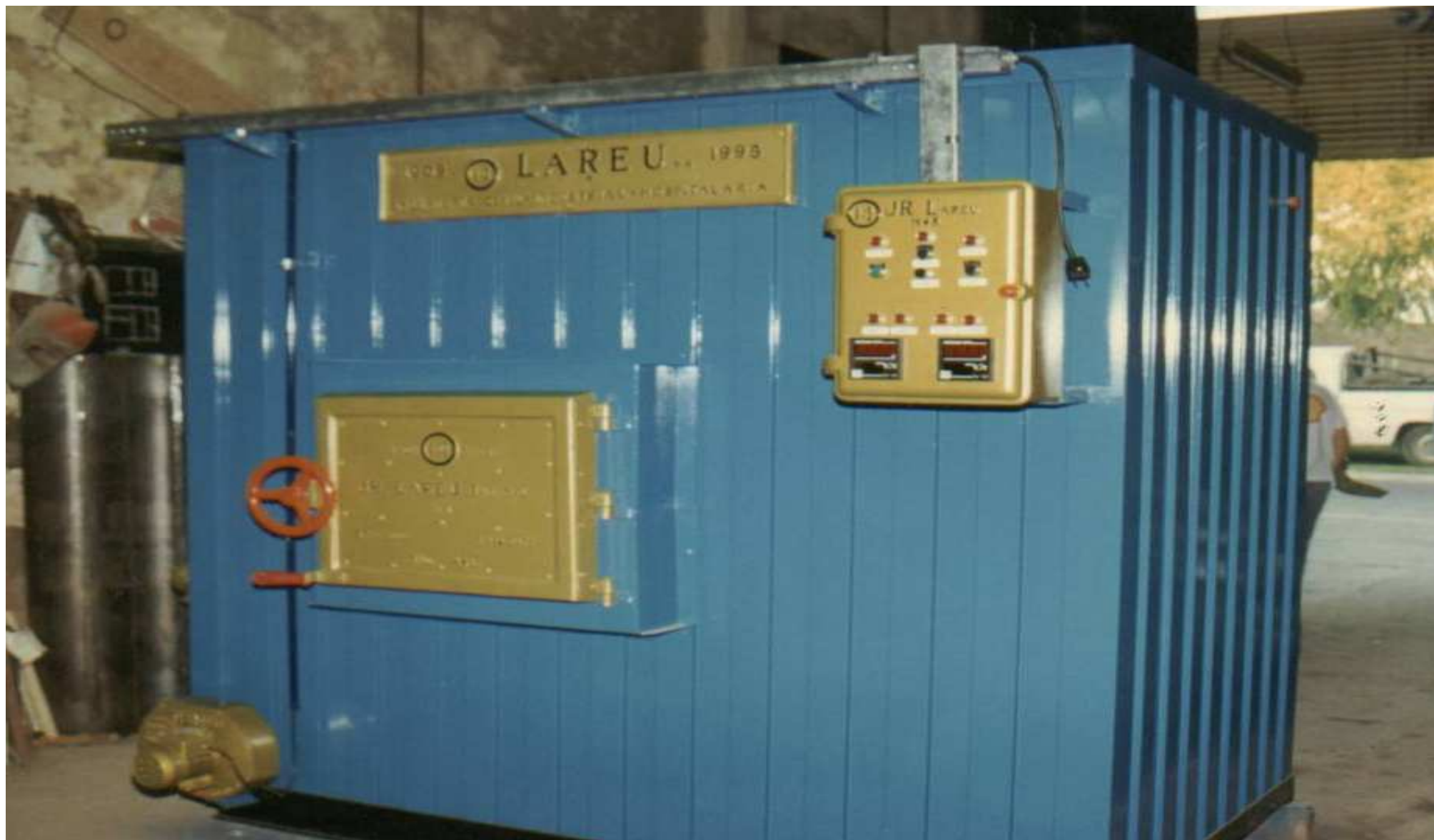
HORNOS CREMATORIOS DE CAMARAS MULTIPLES APTOS PARA EL TRATAMIENTO DE RESIDUOS
